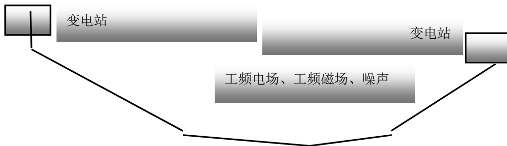
图 4-3 本项目输电线路运营期工艺流程及产污环节图
